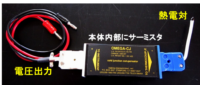
図6. 市販の補償式基準接点の例
